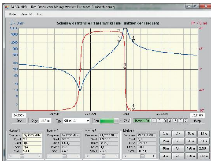
Bild 11: PC-Bedienoberfläche des neuen FA-Antennenanalysators; als Messobjekt diente ein 25-MHz-Quarz mit einer Lastkapazität von 18 pF. Foto und Screenshots: DL1SNG
